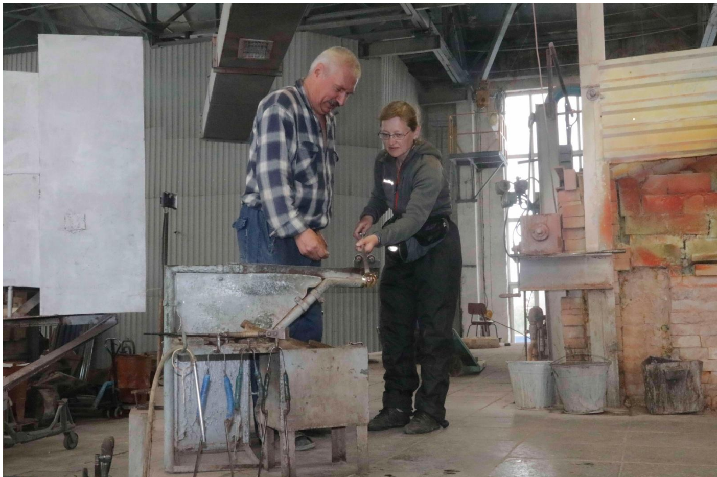
Фото: Завод по производству хрусталя. Процесс выдувания стекла под руководством мастера
